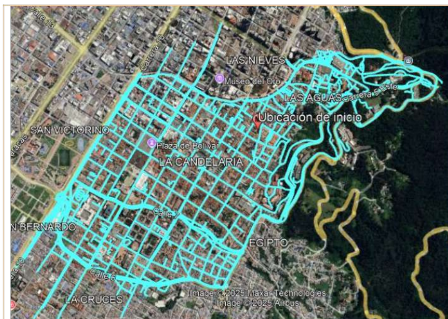
Figura 1. Mapa de ruta propuesta para la medición, en el proceso de preingeniería previo a la realización del Drive Test.
